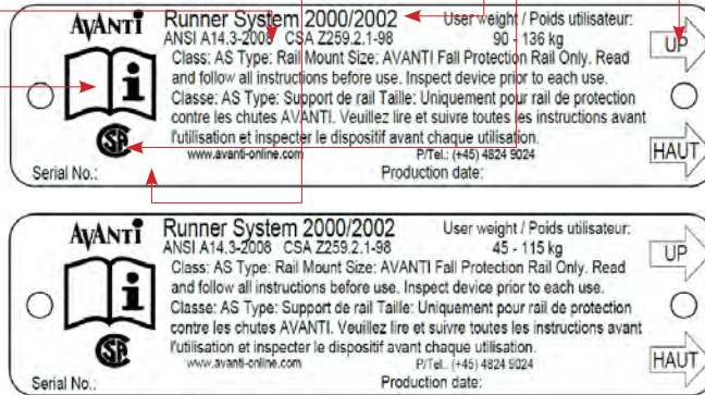
Placa de datos de la corredera (con absorbedor de impactos de clase E6)
