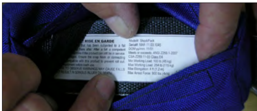
Etiqueta del absorbedor de impactos (clase E4)
