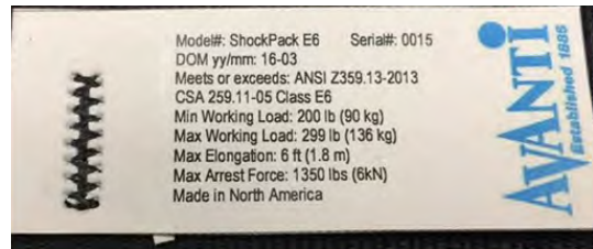
Etiqueta del absorbedor de impactos (clase E6)
